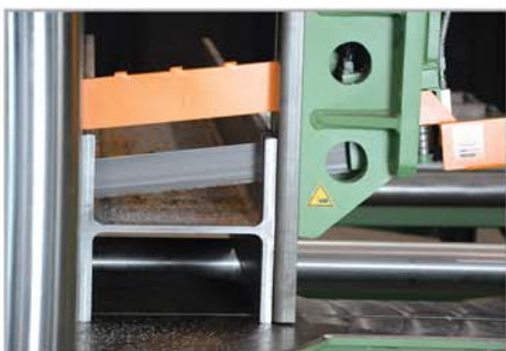
Profils de scie avec un angle d'attaque de 7°
