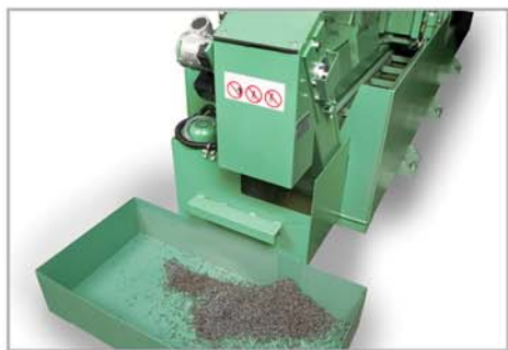
Convoyeur automatique de copeaux pour un entretien simplifié
