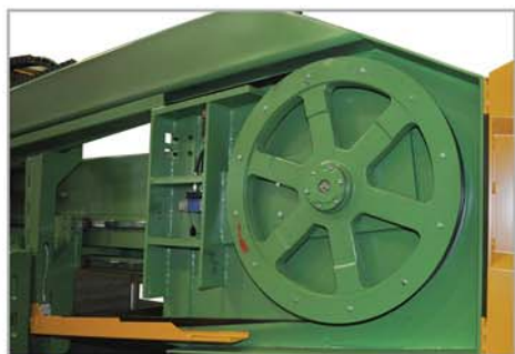
La roue à lames de grand diamètre exige une flexion moins importante de la lame ce qui permet d'allonger la durée de vie des lames
